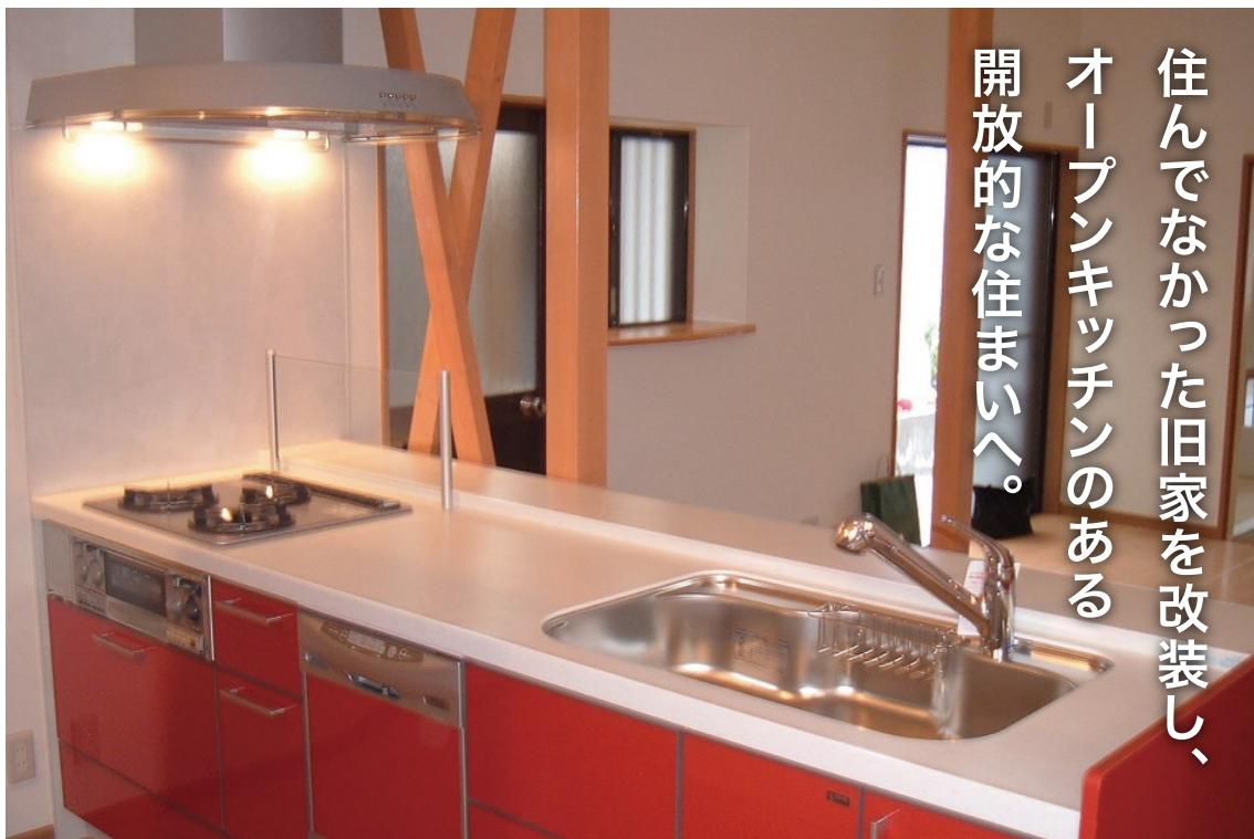
オープンキッチンをレイアウトした前面に、梁の継ぎ手を支える重要な柱が存在。筋交いを入れクリア塗装で仕上げることで、空間に変化が生まれ補強にも役立ち、一挙両得の結果に。
